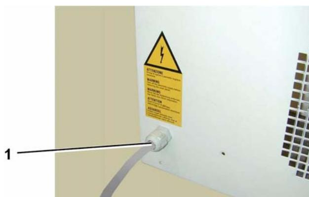
Рекомендуется установить розетку с электромагнитным пускателем и предохранителями вблизи компрессора (на расстоянии не более 3 м).
