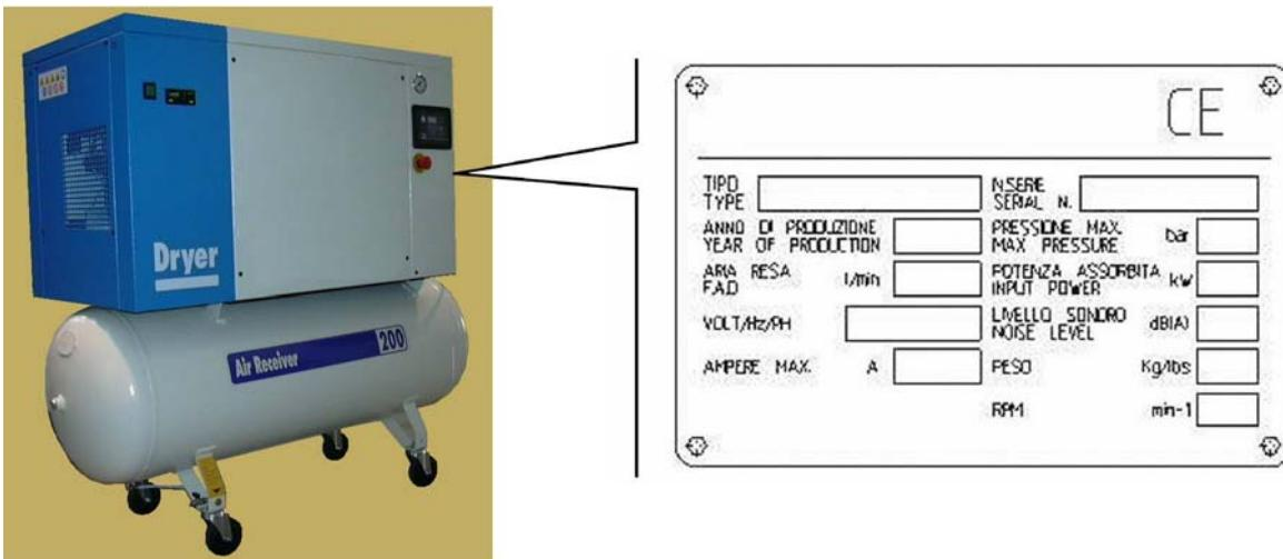
Ротационный малошумный винтовой электрокомпрессор, установленный на ресивере.
